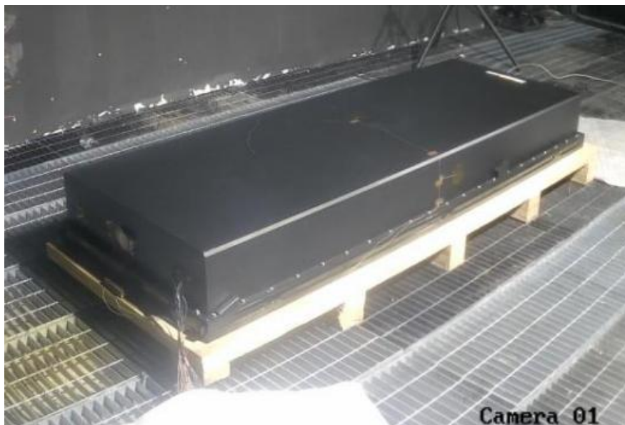
Σχήμα 3: Battery pack, ενδεικτικών διαστάσεων 800 x 250 x 2200 mm, βάρους 600 kg (υλικό προς μεταφορά). Κάθε rack περιλαμβάνει ορισμένο πλήθος cells
